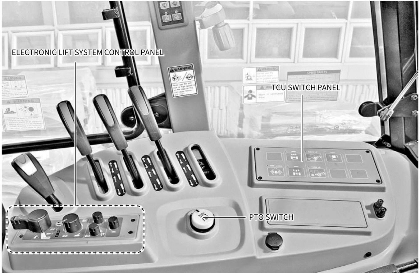
ELECTRONIC LIFT SYSTEM CONTROL PANEL
