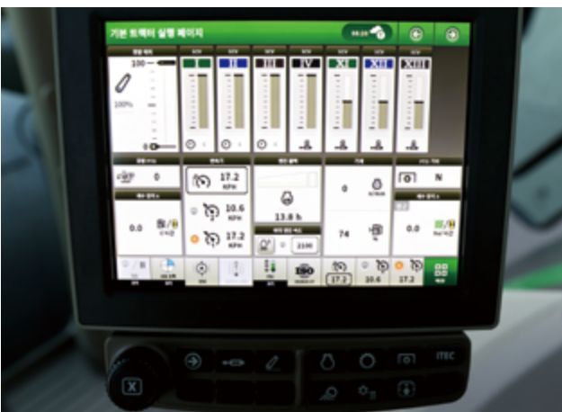
커맨드센터 스크린 iTEC 기능(6R 145이상) → 작업 설정 및 저장 기능
