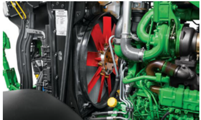
엔진룸 역전팬으로 검불 등의 유입을 억제 및 고출력 유지 (6R 145 이상)
